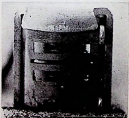
Afb. 1 - Een sterk vervuilde kop van een cassetterecorder.
